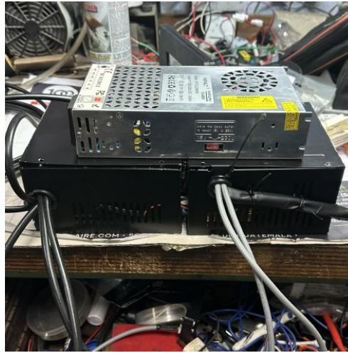
Fig. 1. Caja de control electrónico fabricada a partir de dos carcacas de fuente de poder reutilizadas.
