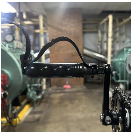
Fig. 2. Manijas del sistema superior fabricadas a partir de empuñaduras de silla de ruedas reutilizadas.
