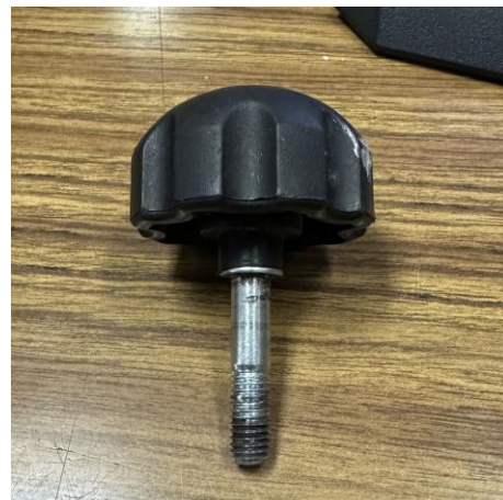
Fig. 3. Tornillos con perilla fabricados a partir de perillas de equipo institucional reutilizadas.
